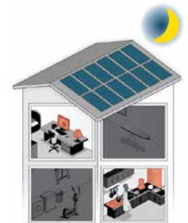
Notte: Carichi importanti vengono alimentati dalla batteria
